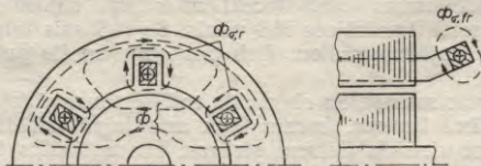
5.28. zīm. Maiņstrāvas mašīnas statora tinuma magnētiskais lauks.
