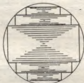
4.6. zīm. Transformatora serdes šķērsgriezums.
