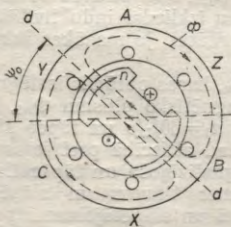
7.45. zim. Sinhronā ģeneratora magnētiskais lauks pirms pēkšņā išslēguma.
