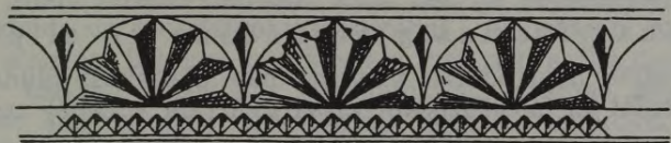
Zīm. 633. Kā iedziļinājumi pamatkokā veidoti koktēlnieka rotājumi.
