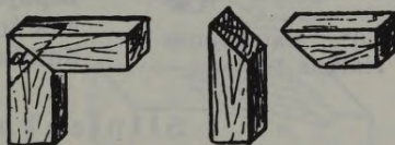
Zīm. 605. Taisnā leņķī veidoti slīpsaduru sējumi.
