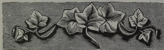
Zīm. 637. Koktēlnieka rotājumu veidošana, pazeminot pamatplātnes virsmu visapkārt izceļamam zīmējumam.
