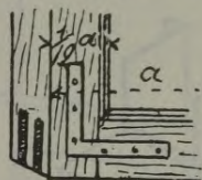
Zīm. 671. Loga vērtnes stūra sējums ar divkāršu starpas tapu, pastiprinātu ar dzelzs uzstūreni.
