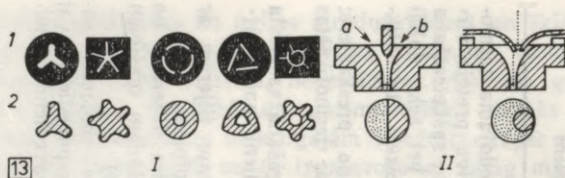
Daži filjeru atvēruma veidi (I) profilētu šķiedru (2) iegūšanai (I); divkomponentu šķiedru šķērsriezumi un filjeras to formēšanai (II)
