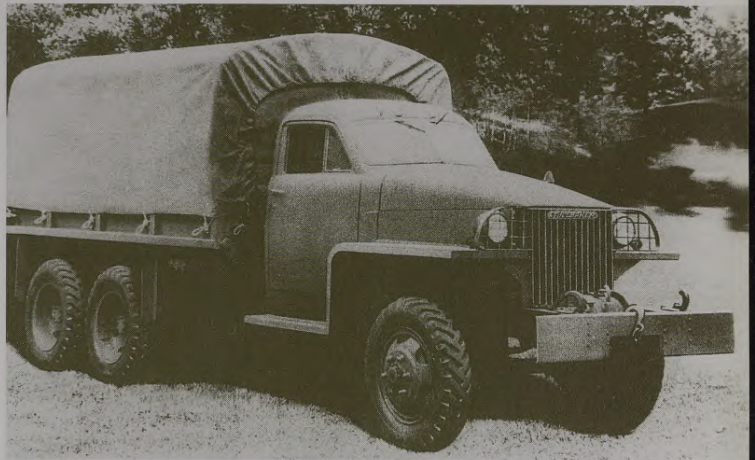
Populārākais importa kravas automobilis Padomju armijā Otrā pasaules kara laikā - 95 ZS "Studebaker US-6". The most popular lend-lease truck in the Soviet Army during WW2 - the 95 hp "Studebaker US-6".
