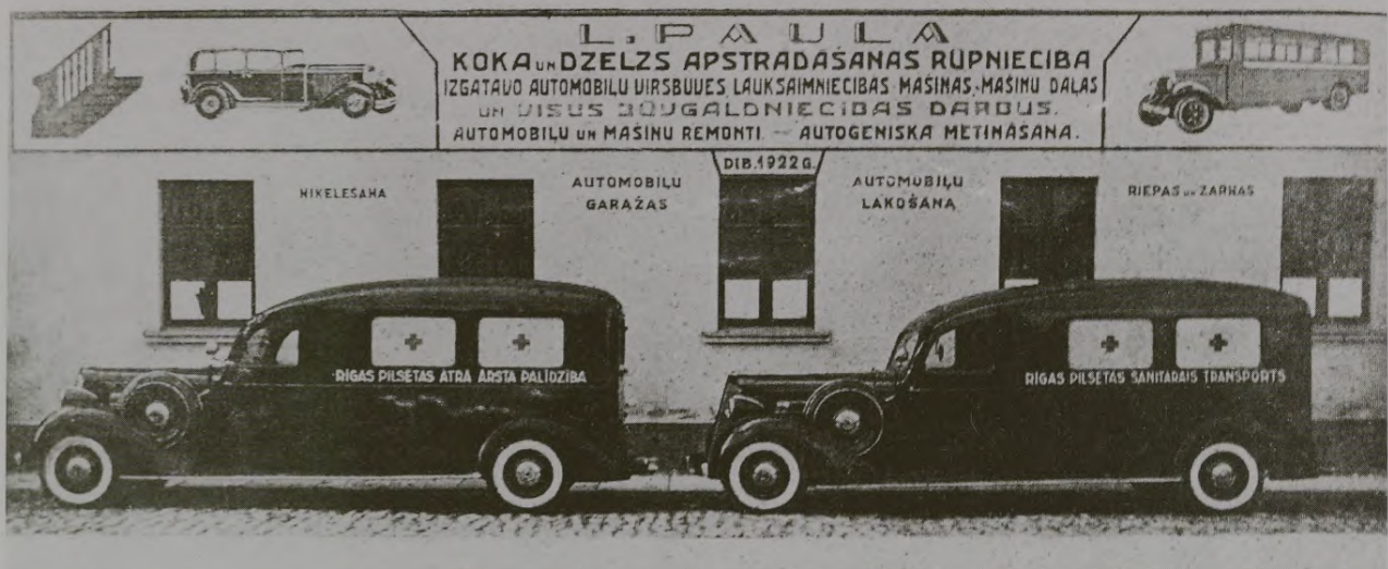
L. Paula uzņēmumā Jelgavā būvētās sanitāro automobiļu virsbūves uz "Packard" šasijām. 30. gadi. Ambulances built on "Packard" chassis at L. Pauls' company in Jelgava. The 30's.
