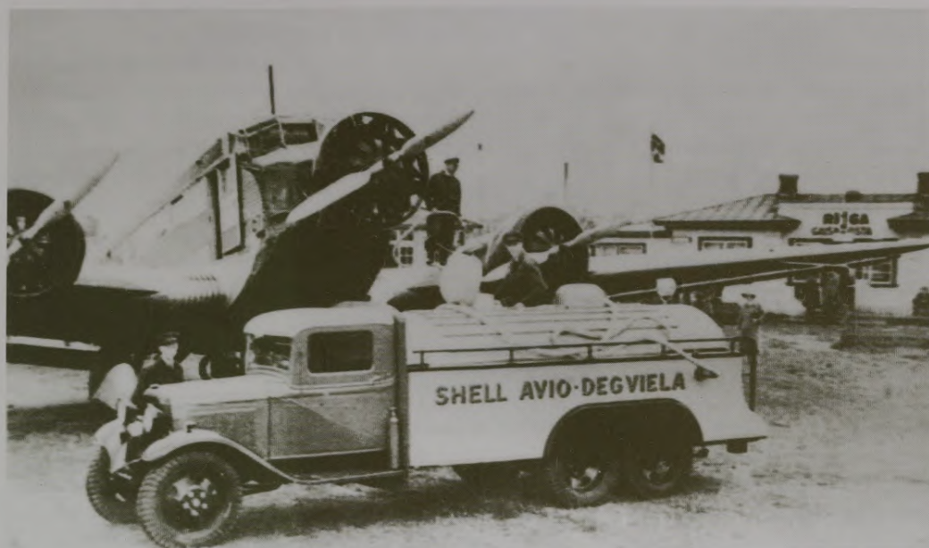
Rīgas gaisa osta Spilvē. Degvielas iepildīšana satiksmes lidmašīnā Ju-52. 30. gadi. Riga's Spilve Airport. A Lufthansa passenger aircraft Ju-52 is being refueled. The 30's.
