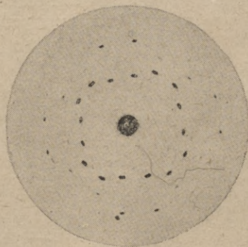
1. att. Cinka sulfida radīts X - staru spektrs pēc Laue's
