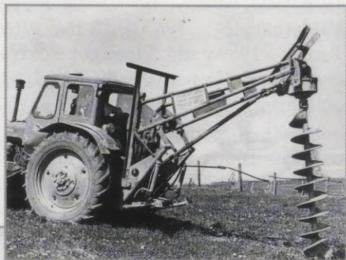
■ Traktors Belarus ar balstu bedru urbšanas mehānismu
