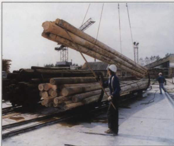
■ Viktors Plotņikovs un Leonīds Mazurskis iekrauj vagonētēs nomizotos balstus pirms piesūcināšanas autoklāvā
