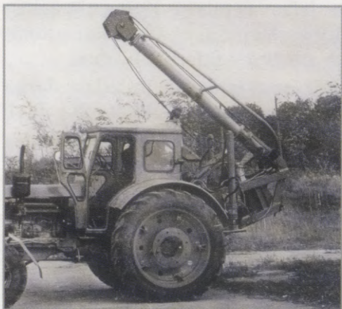
■ Balstu izvilcējmehānisms. Racionalizātori: H.Prūsis, N.Nazarecs, 1977.gadā
