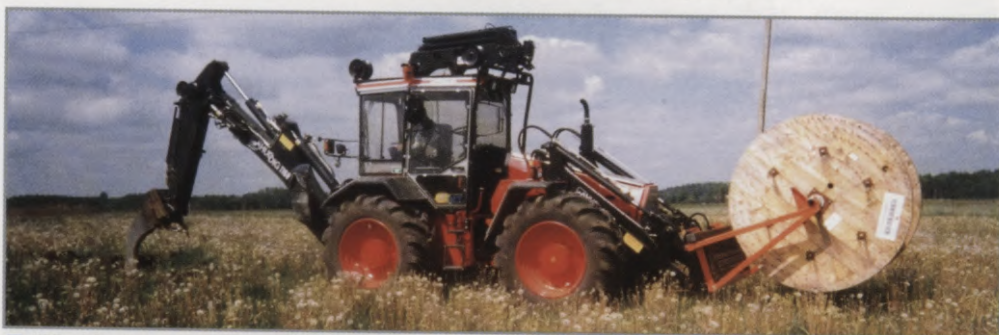
■ "Huddig" - universāla mašīna elektrolīniju ierīkošanai un ekspluatācijai, 1999.gadā
