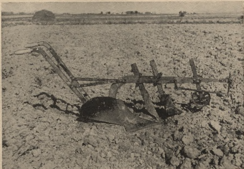
Kultūrtipa arkls ar priekšlobītāju un atbalsta ritenīti uz labiem arumiem
