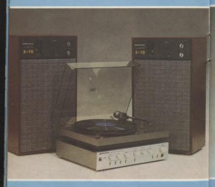
Стационарный блочный комплект электропроигрывателя. Включает: электропроигрыватель «Ария-102-стерео», предварительный усилитель «Радиотехника УП-001-стерео» и две активные акустические системы «S-70» [со встроенными усилителями мощности].
