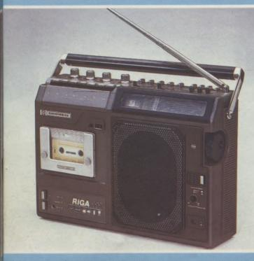
Переносная мономагнитола объединяет всеволновый радиоприемник с расширенным составом диапазонов [ДВ, СВ, УКВ и 4 КВ] и кассетный магнитофон с замедленно открываемым кассетоприемником.
