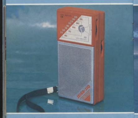
Переносной, двухдиапазонный радиоприемник.
