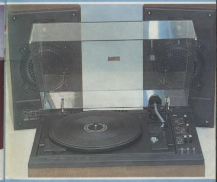
Состоит из электрофонного устройства [электропроигрывающее устройство 2-ЭПУ-65СМ и стереофонический усилитель] и двух акустических систем «S-20A».
