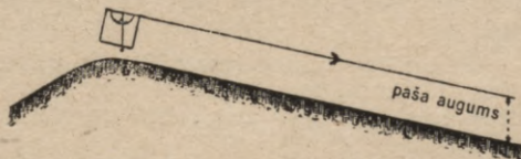
58. zīm. Nogāzes stāvuma mērīšana ar eklimetri.
