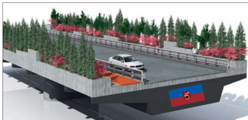
4. skīču variants paredz dzīvo stādījumu divpakāpju rindu abās tilta pusēs, kas radīs garas zaļās alejas iespaidu un kalpos par skaņas barjeru.
