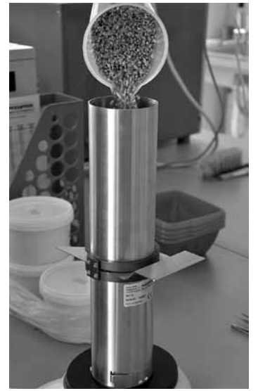
Elektroniska ierīce nosaka tilpummasu, kāda vajadzīga absolūti precīziem mērījumiem.
