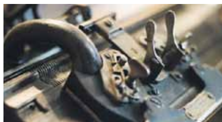
Adāmmašīnai sānos skaitītājs rāda, cik griezīnu uztaisīti. Šādi kāds rūpnīcas īpašnieks varēja paveikto kontrolēt.
