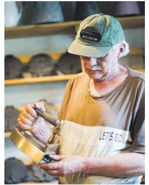
Olafs rāda misiņa gludekli noslēpto dvēseli, kas vispirms jākarsē, lai gludekli pēc tam lietotu.
