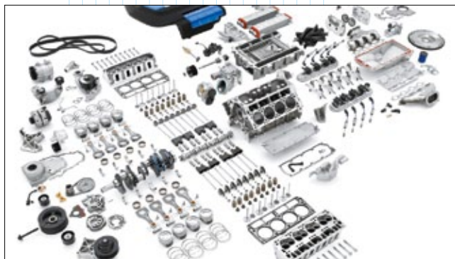
Рис. 2. Двигатель LS9 производства General Motors в полуразобранном состоянии (источник: “Автостар”)
