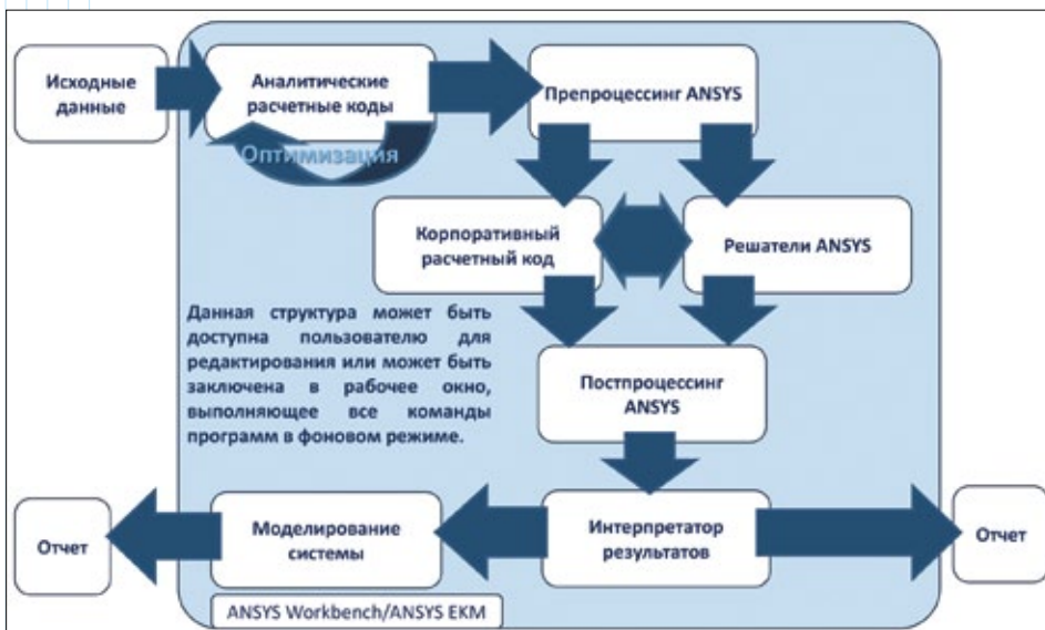
Рис. 10. Интеграция упрощенных аналитических расчетных методик с комплексами численного моделирования в рамках концепции 1D-3D-1D в единой расчетной среде
