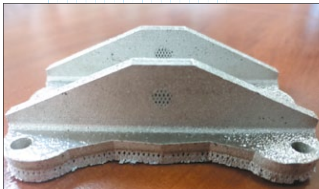
Рис. 8. Заготовка кронштейна, напечатанная из материала Inconel625
