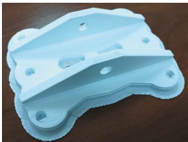
Рис. 6. Макет кронштейна, напечатанный из материала ABS
