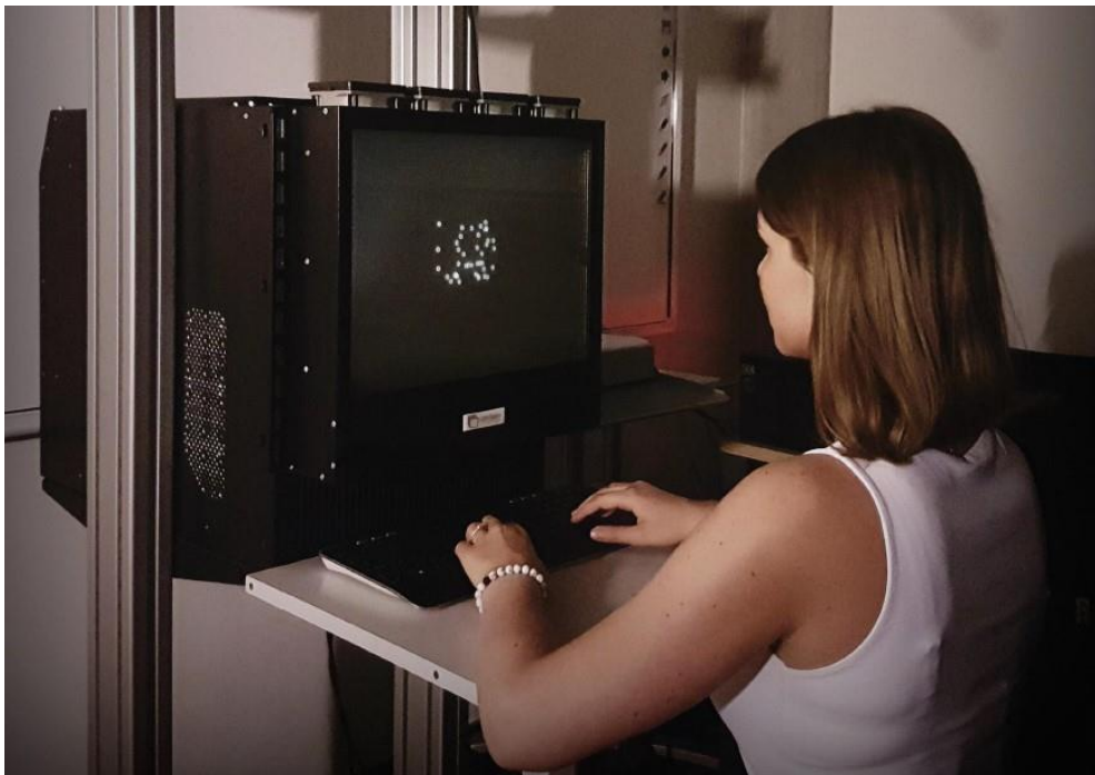
5. att. Eksperimentālais izkārtojums, kad meklēšanas veida uzdevums tika pildīts uz “ LightSpace Technologies ” volumetriskā ekrāna. Attēli tika demonstrēti uz vairākām ekrāna plaknēm patiesā dziļumā.
