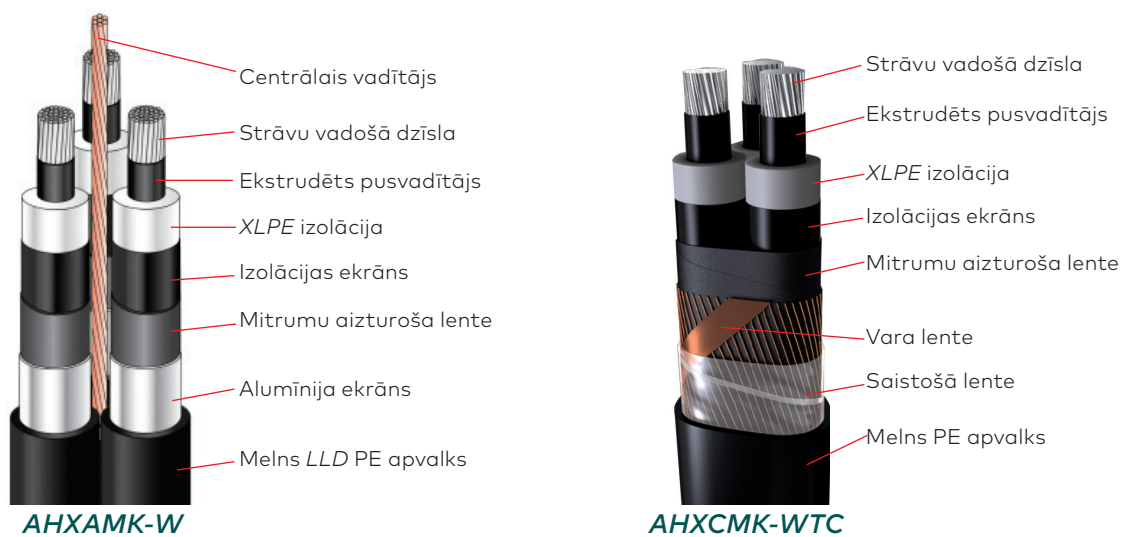
1.14. att. Vidsprieguma kabeļu konstrukcija.
