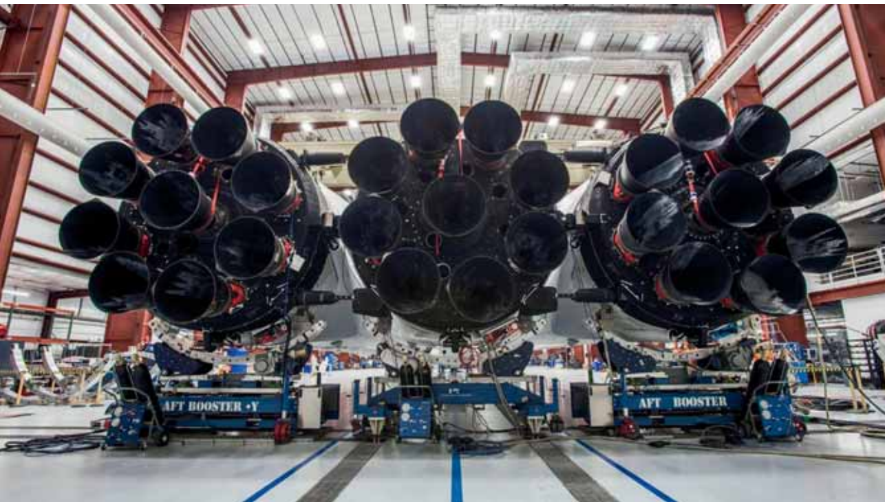
Falcon Heavy raķetes pirmā pakāpe izmanto 27 Merlin 1D petrolejas un šķidrā skābekļa raķešdzinējus, kuri kopā atfīsta 2,3 tūkstošu tonnu vilci, kamēr raķetes pilnā masa ir tikai 1,4 tūkstoši tonnu. SpaceX foto
