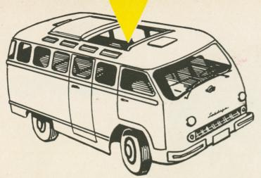
Раздвижная крыша из гнутого дымчатого стекла открывается без усилий и незаменима летом. В плохую погоду и зимой она полностью герметична.
