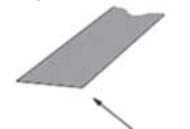
“Пятка” ледобура ниже режущей кромки, бур не бурит (схематично).
