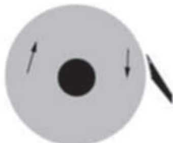
На рисунке изображено правильное положение ножа по отношению к наждачному кругу. Режущая кромка – сверху (схематично).
