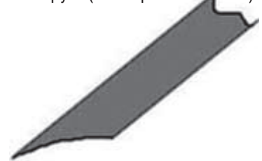
Правильно заточенная форма ножа (схематично).
