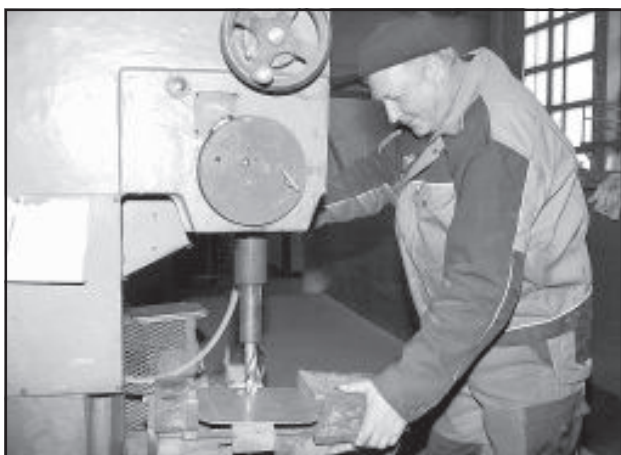
Гунарс Нитиш изготавливает основы для резервуаров.
