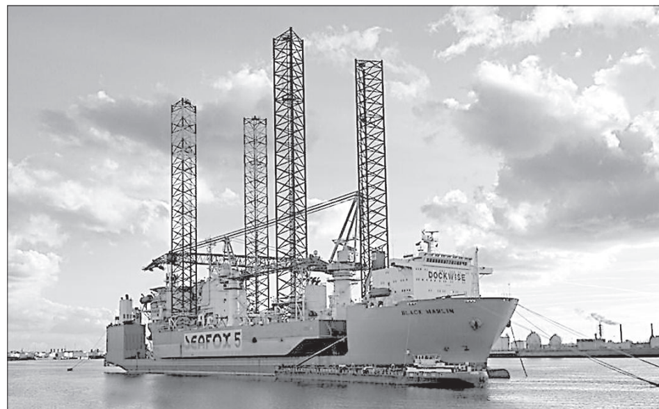
Судно «Black Marlin» предназначено для транспортировки сверхтяжелых грузов.
