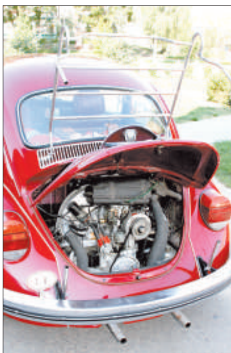
Двигатель располагается сзади.
