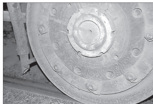
Трубочка возле колеса сыплет на рельсы песок.
