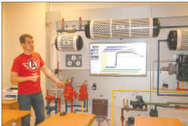
Максим Кенигс демонстрирует учебный стенд тормозов.
