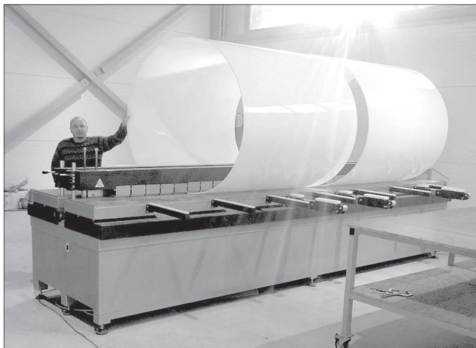
В Ликсне работает мощное оборудование по сварке пластмассы.
