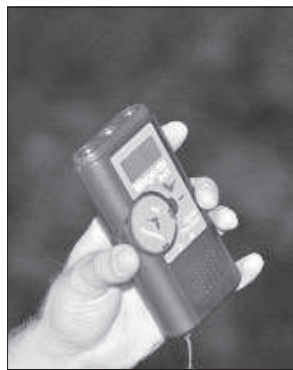
С помощью детектора «Heterodyne» можно услышать ультразвук, создаваемый насекомыми.
