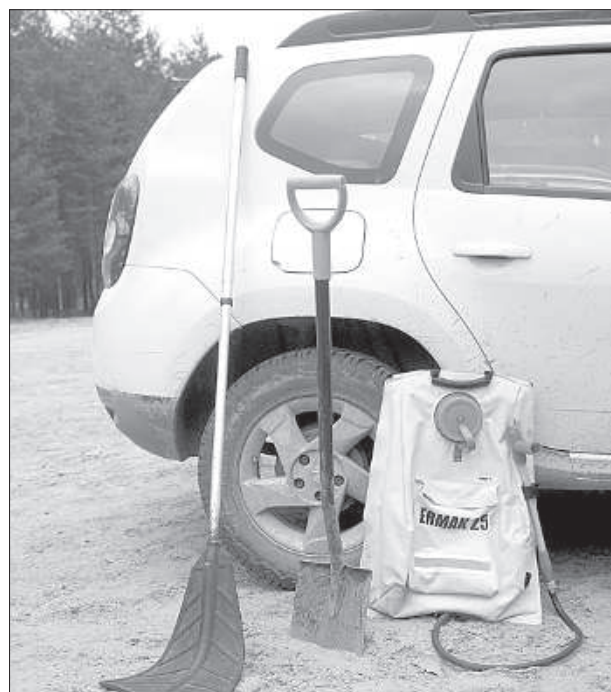
Простейшее оборудование лесника: «весло» для сбивания пламени, лопата и емкость с насосом.
