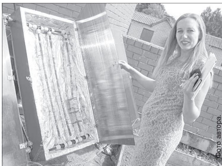
Учительница Йоланта Маценко пояснила, что черные трубы и каркас ящиков выбраны специально, чтобы солнечная панель «притягивала» как можно больше тепла.
