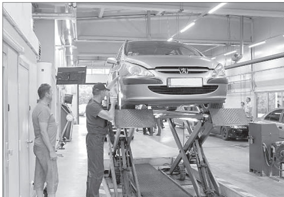
Идет проверка подвески и шин.
