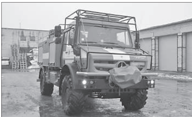
Новая пожарная машина сможет проехать через реку или канаву глубиной 1,3 м.
