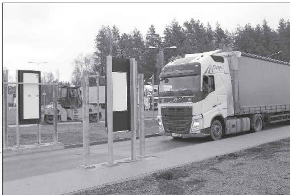
Установлены ворота радиации, которые позволят проверять грузы нестандартного размера и крупногабаритные транспортные средства.
