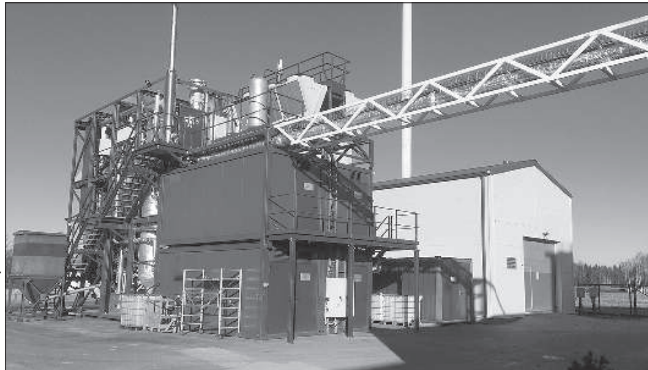
Новый блок газификации биомассы, из произведенного здесь газа получается биотопливо второго поколения.
