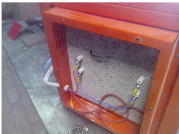
3.33. att. Temperatūras datu mērītāji pārbaudāmajā izolācijas materiālā
