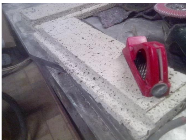
3.31. att. Plātnes ir viegli apstrādāamas ar rokas instrumentiem.
