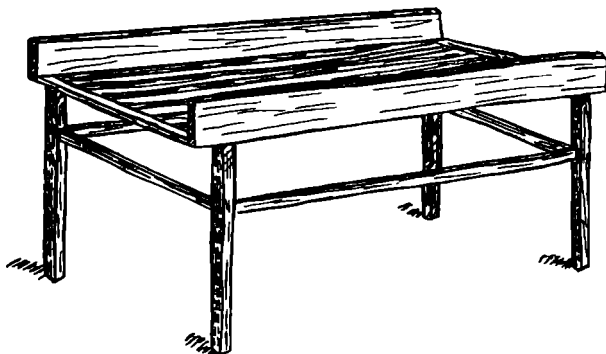
10. attēls. Reža salmu atšķiršanai no smalkumiem. Parasti apm. 90 cm augsta un kādus 150—160 cm gara. Restes apaļa vai stūrainā koka, apm. 3—4 cm resnas, atstarpes starp tām kādus 5 cm platas.
