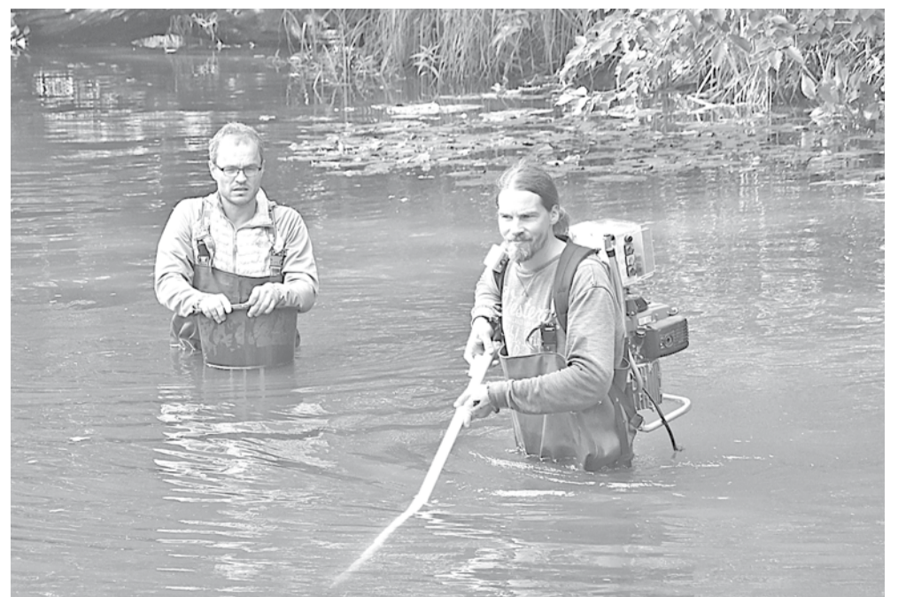
Zinātniskās elektrozeļu aparāts ir smalks instruments, kas zivis tikai uz brīdi apdullina, lai varētu noteikt to sugu un izmērīt garumu.
