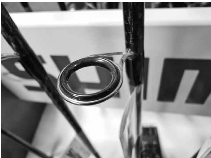
Kā pārbaudīt, vai makšķeres gredzeni ir labi? Ņem talkā sieviešu izsektes un izvelk cauri, lai redzētu, vai tie ir gludi.
