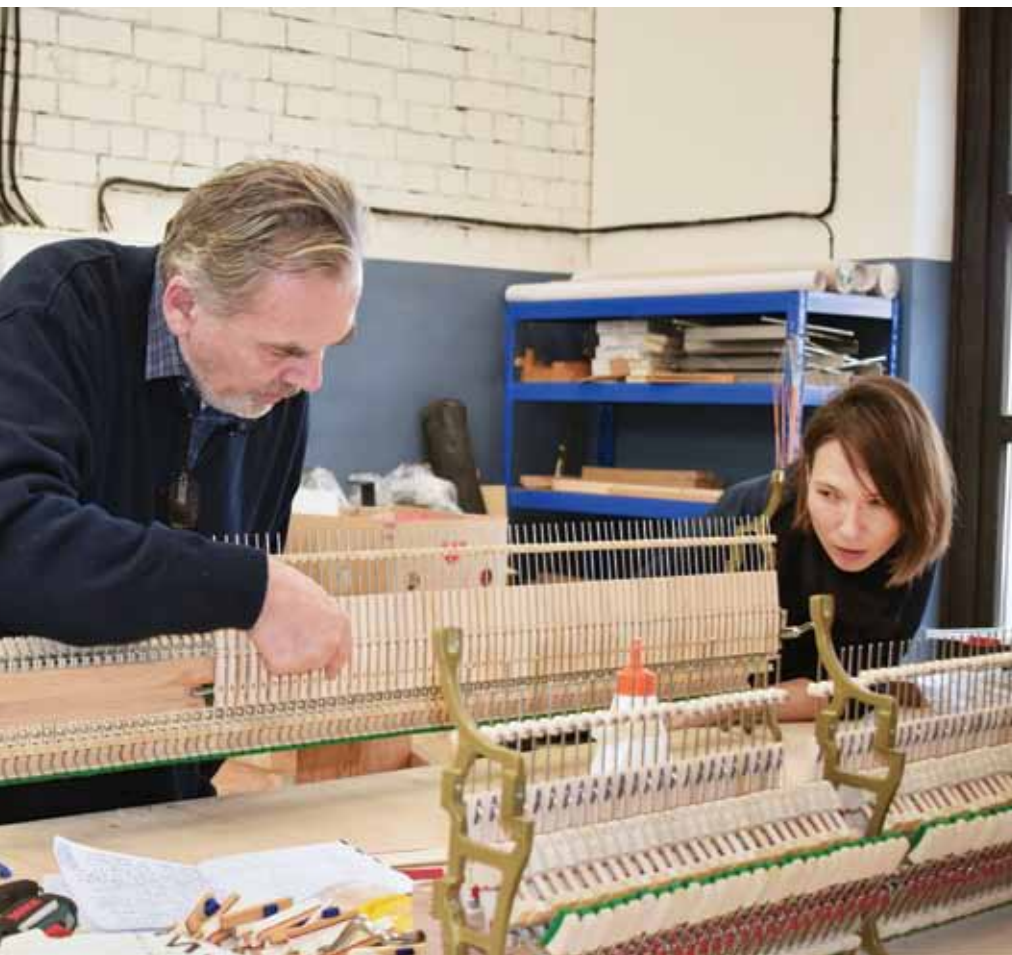
Top jaunas klavieres, un meistars Dāvids Kļaviņš rāda kolēģei Majai Līcītei, kāds instrumenta būvniecībā ir nākamais solis.
