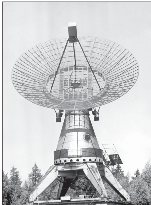
7. att. Spoguļantena (diametrs 10 m, izgatavota Vladimīrā), ar ko no 1972. līdz 1993. gadam reģistrēja Saules integrālo radiostarojumu un tā kvazi-periodiskās fluktuācijas decimetru viļņos.
