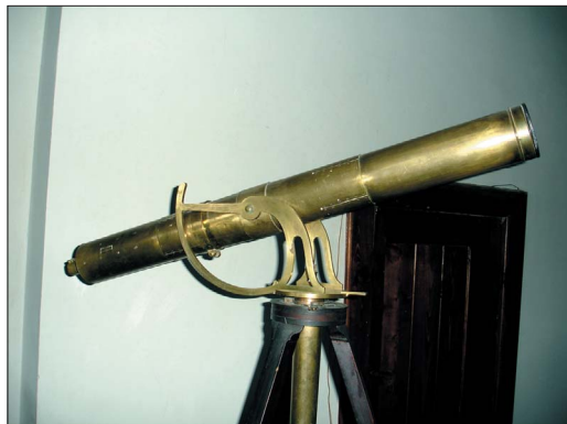
4. att. Dolonda ahromatiskais teleskops. Stobra garums 106 cm, objektīva diametrs 9 cm. Dž. Ramsdena montāža. Instruments izgatavots 18. gs. otrajā pusē Anglijā.
