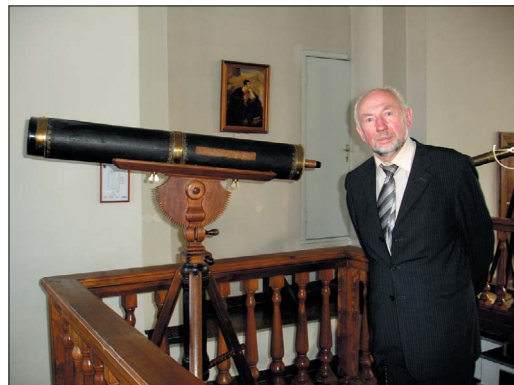
3. att. Vecākais Viļņas observatorijas instruments – koka refraktors. Stobra garums 106 cm, objektīva diametrs 14 cm. Refraktors izgatavots 18. gs. Anglijā. Pie instrumenta raksta autors prof. L. Klimka.
