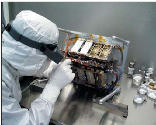
Ķīmisko analīžu krāsns TEGA ar gāzu analizatoru. NASA/Arizonas universitātes foto
