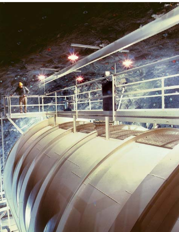
Houmsteikas Saules neitrīno eksperimenta tvertne ar 615 tonnām perhloretilēna.
