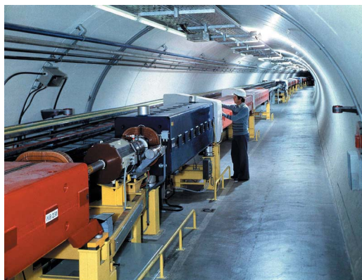
2. att. Superprotonu sinhrotrons – augstas enerģijas protonu inžektors Lielajā hadronu paātrinātājā, kurā tika radīti OPERA eksperimentam nepieciešamie neitrino.
