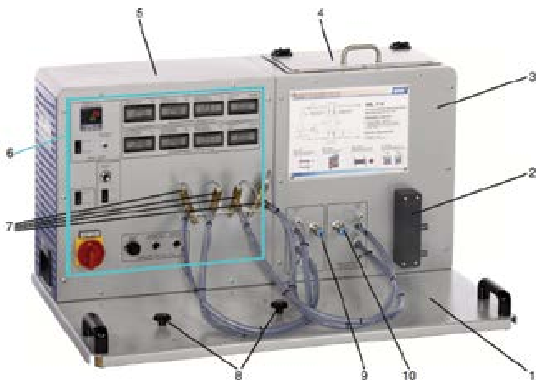
2.14. att. Siltummaiņa iekārta WL110 : 1 – pamatne; 2 – savienojuma bloks; 3 – korpuss ar iekārtas shēmu; 4 – siltā ūdens rezervuārs ar elektrisko sildelementu; 5 – korpusa turpinājums; 6 – vadības panelis; 7 – spraudkontakti, 8 – skrūves siltummaiņa piestiprināšanai; 9 – karstā ūdens ventiļi; 10 – aukstā ūdens ventiļi.
