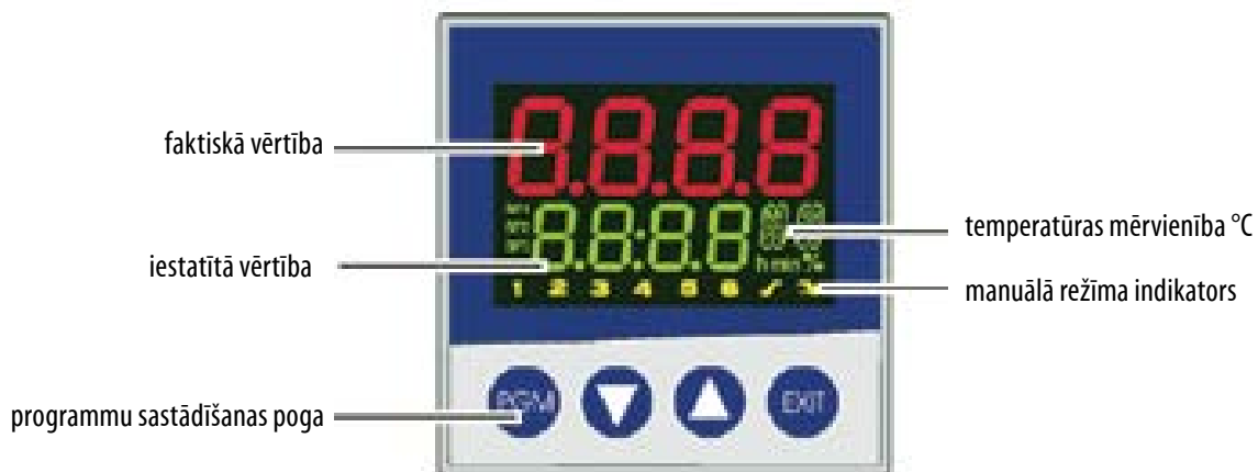
4.12. att. Temperatūras kontrolieris T13 regulēšanai. Ar bultiņām regulē iestatāmās vērtības uz augšu vai leju. Ar pogu EXIT (pieturot dažas sekundes), ierīces darba režīms pārslēdzas no manuālā uz automātisko un otrādi.
