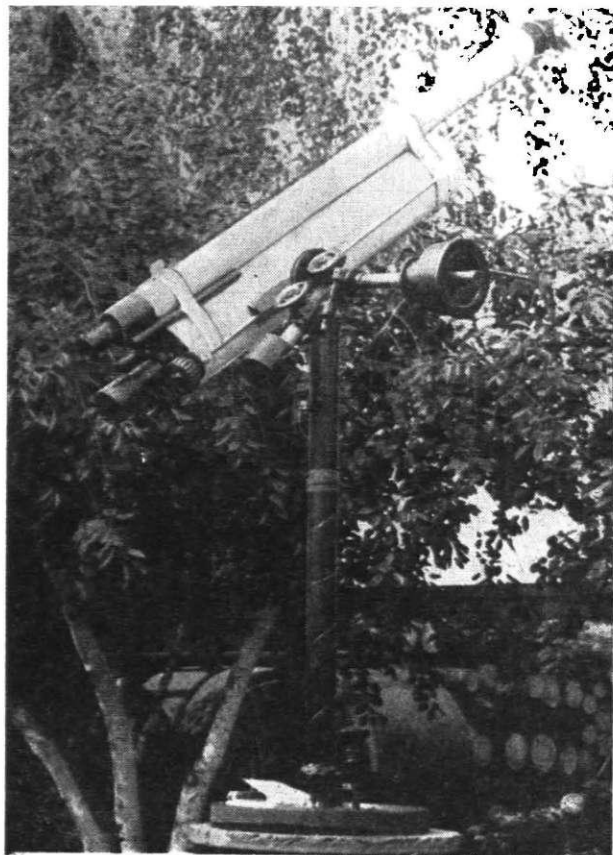
29. att. Teleskops uz ekvatoriālā statīva. Labi redzamas rektascensijas (polārā) un deklinācijas ass.
