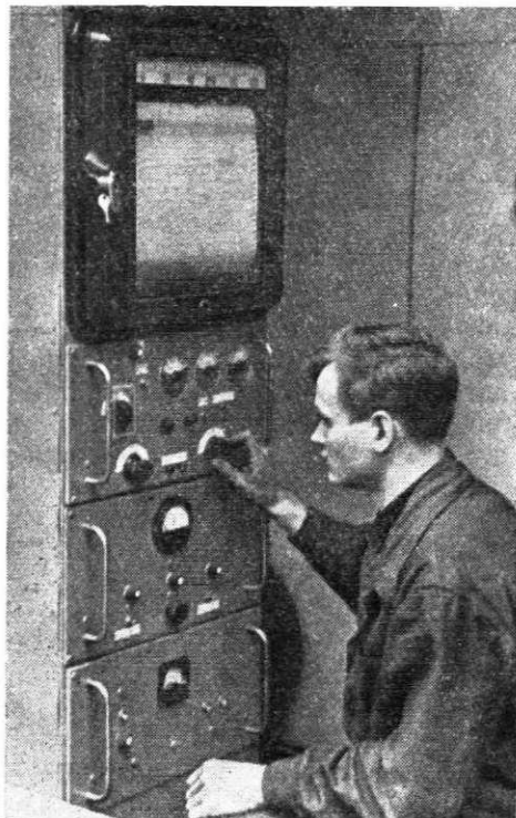
21. att. Zvaigžņu elektriskais fotometrs.
