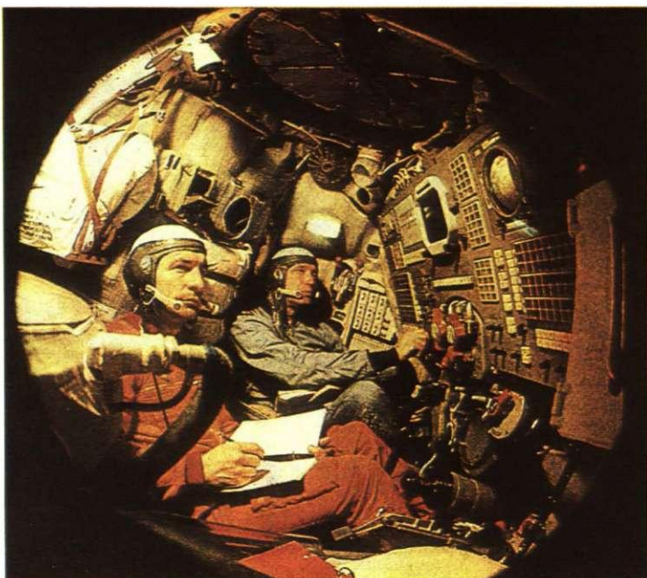
Pilotējamā transportkuģa «Sojuz T» nolaižamā aparāta iekārtojums (skats caur ieejas lūku): augšā — lūka pārejai uz orbitālo nodalījumu, pa labi — galvenā vadības pults (vidū — kuģa ESM displejs), apakšā — trešais sēdekļis.
