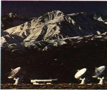
ASV mainīgas bāzes radiointerferometrs Ouensvelijā sastāv no trim 10,4 m antenām, kuras piemērotas arī milimetru viļņu radiostarojuma uztveršanai.
