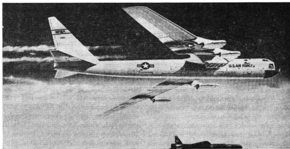
2. att. Kosmiskās nesējraķetes «Pegasus» palaišana no lidmašīnas B-52 «Stratofortress». (Pēc «Hercules Aerospace» materiāliem.)
