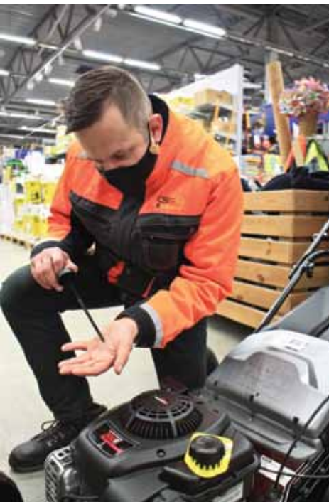
Liepājas veikala K Senukai pārdevējs Normunds rāda, kur benzīna plaujmašīnai jāapskata eļļas līmenis. Pie tvertnes vāciņa ir piestiprināts mērs, kam visu laiku jābūt līmeņi starp divām atzīmēm apakšdaļā.
