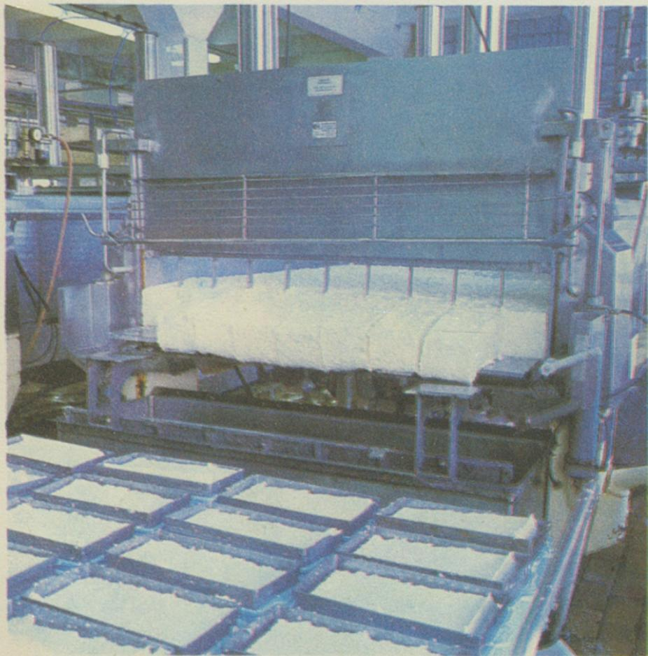
Vertikālo pneimatisko spiežu izmantošana ļauj sasniegt jo viļākā augstums siera presēšanas pakāpi, kas savukārt ir gaītā produkta teicamas kvalitātes priekšnosacījums.
