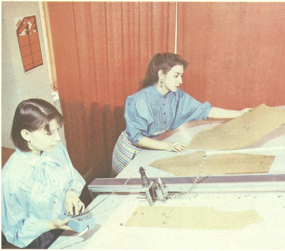
Apdzīvotā «Rīgas modes» pieļieko elektro-nisko skaitlošanas tehniku. Tā dod iespēju labāk sagatavot ražošanu, kvalitatīvi un vis-īsākajā laikā sākt jaunu šūšanas un trikotāžas izstrādājumu modeļu iz-laidi.
